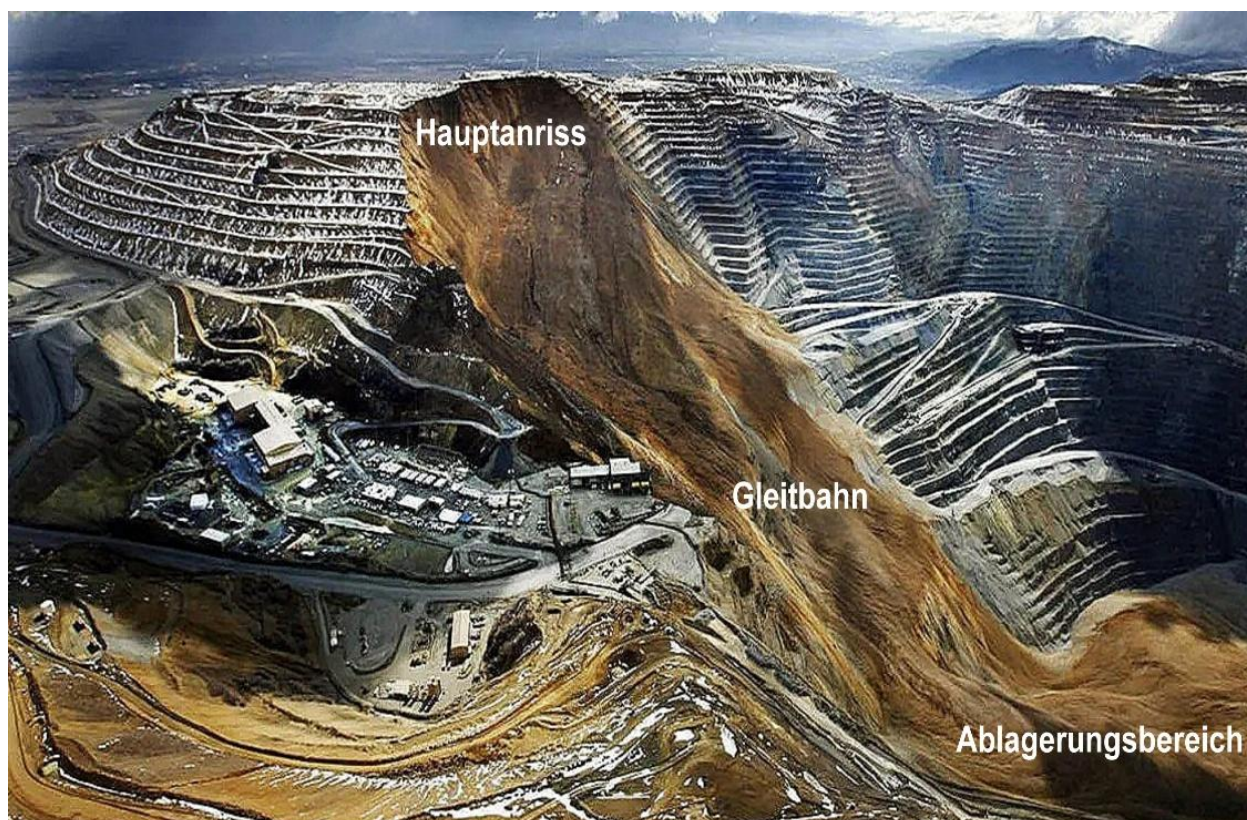
Abb. 15 Rotationsgleiten als globales Böschungsversagen (NBC News)
